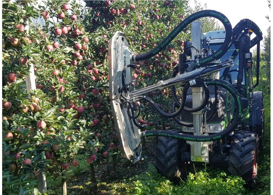
Das Konzept und die Bauart vom Rahmen und der Arbeitsköpfe sind in Zusammenarbeit mit Südtiroler Landwirten entwickelt worden: die besondere Bauart und die verschiedenen Regulierungsmöglichkeiten ermöglichen eine präzise Arbeitsweise auf beiden Seiten der Pflanzreihe. Durch die Rotation des Arms von über 180° kann die Maschine komplett auf die andere Seite geschwenkt werden. Somit ist eine Bearbeitung der Schattenseite ohne Leerfahrten möglich.
