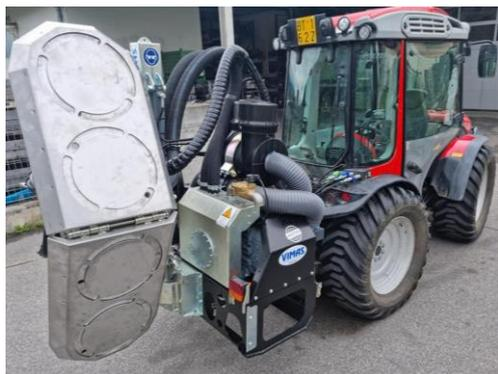
Kompakte Entlaubungsmaschine in Heck- oder Frontanbau
