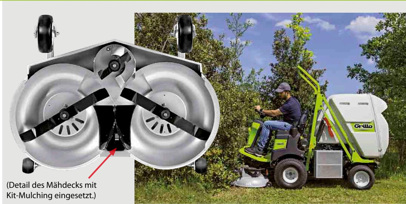
(Detail des Mähdecks mit Kit-Mulching eingesetzt.)
